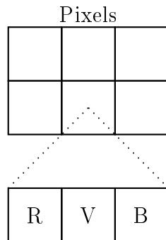
Il est ainsi possible de chiffrer une image comme on chiffre un texte : à l'aide d'un chiffrement XOR et d'un masque jetable. Le masque jetable peut être une autre image mais pas nécessairement. Dans le cas d'une image, on récupère les niveaux de rouge, de vert et de bleu de chaque pixel de l'image et du masque pour créer une nouvelle image dont les pixels seront le résultat de la fonction XOR appliquée à chacun de ces niveaux.
