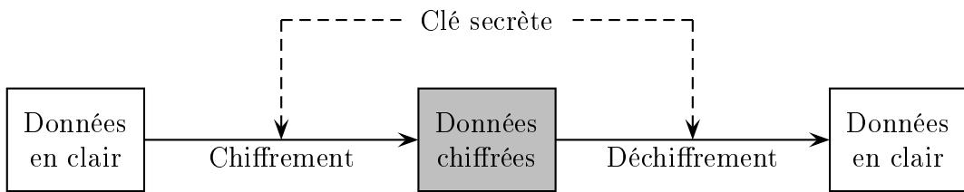
Un chiffrement symétrique a pour avantage d'être généralement rapide et convient donc bien à des échanges d'importantes quantités de données. Il peut aussi être très sûr comme par exemple le masque jetable ; lequel est inviolable et a notamment été utilisé pour le fonctionnement du téléphone rouge entre le Kremlin et la Maison Blanche.
